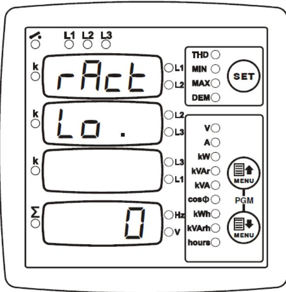
Данное конфигурационное значение задает нижний предел реактивной мощности, при достижении которого срабатывает сигнал.
