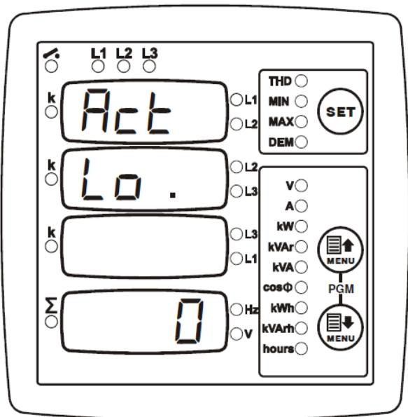
Данное конфигурационное значение задает нижний предел активной мощности, при достижении которого срабатывает сигнал.
