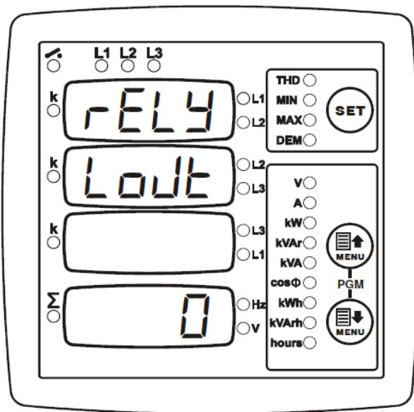
Релейный выход – комбинация 4 функций, описанных выше. Таким образом, на релейный выход могут быть назначены комбинации функций.
