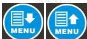
Для того, чтобы выйти из меню настроек, удерживайте нажатыми обе кнопки MENU в течение 2 секунд. При отсутствии нажатий на кнопки в течение 1 минуты выход из меню настроек произойдет автоматически.
