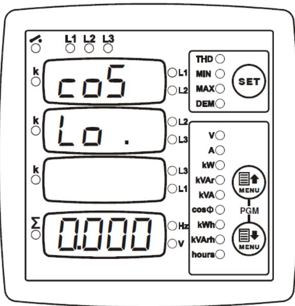
Данное конфигурационное значение задает нижний предел  $\cos\phi$ , при достижении которого срабатывает сигнал.
