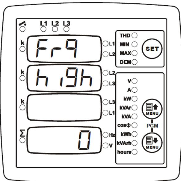
Данное конфигурационное значение задает верхний предел частоты, при достижении которого срабатывает сигнал.
