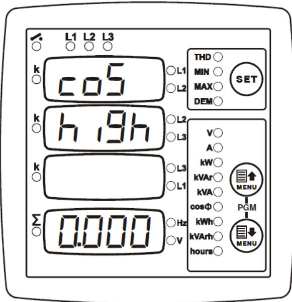
Данное конфигурационное значение задает верхний предел  $\cos\phi$ , при достижении которого срабатывает сигнал.
