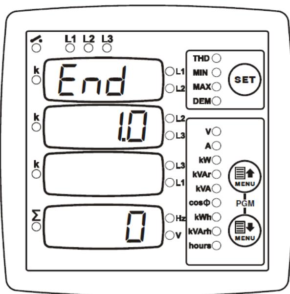
Версия встроенного ПО анализатора выводится на второе сверху табло на шаге настроек, обозначаемом словом End в верхнем табло.
