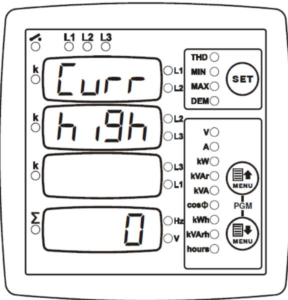
Данное конфигурационное значение задает верхний предел для сверхтока, при достижении которого срабатывает сигнал.
