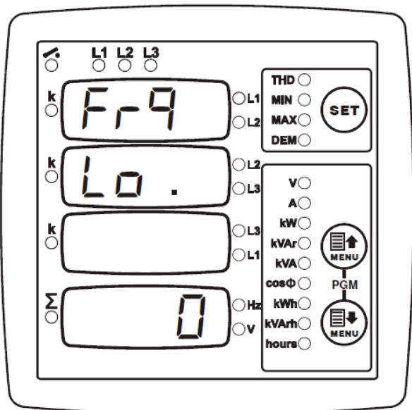
Данное конфигурационное значение задает нижний предел частоты, при достижении которого срабатывает сигнал.
