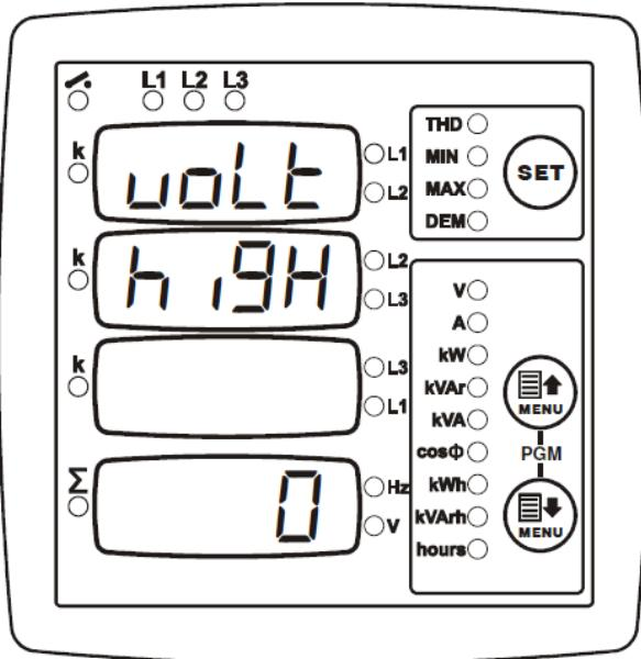
Данное конфигурационное значение задает верхний предел напряжения, при достижении которого срабатывает сигнал.
