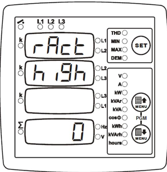
Данное конфигурационное значение задает верхний предел реактивной мощности, при достижении которого срабатывает сигнал.
