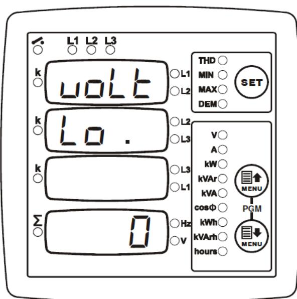
Данное конфигурационное значение задает нижний предел напряжения, при достижении которого срабатывает сигнал.
