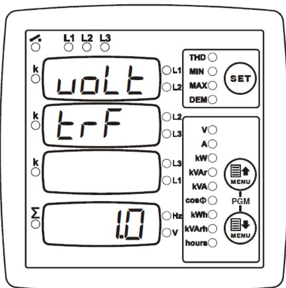
Данные настройки позволяют задать коэффициент для трансформаторов напряжения.
