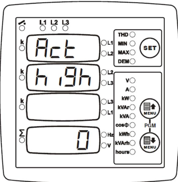
Данное конфигурационное значение задает верхний предел активной мощности, при достижении которого срабатывает сигнал.
